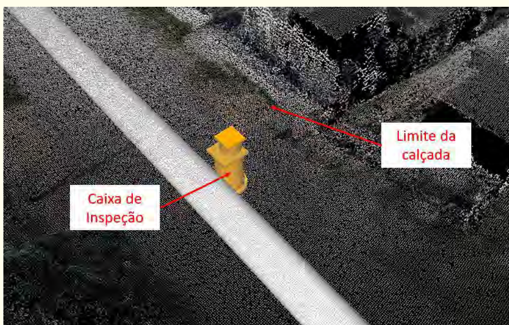
Figura 5: Perspectiva de uma das caixas de inspeção relocadas.
